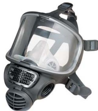
Promask оснащена лицевой частью с широким Т-образным краем уплотнения, прозрачной внутренней маской с 2 клапанами, 5-конечным резиновым ремнем с пластиковыми пряжками для простоты снятия маски, а также переговорной диаграммой и панорамной линзой.
