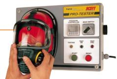
**ProTester** – простое и надежное устройство для проверки герметичности маски.
